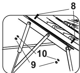
**ВНИМАНИЕ!** Газлифт крепится на подъемный механизм цилиндром вверх как на схеме.
