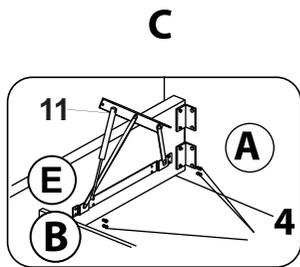
Крепление подъемного механизма к боковым царгам (газлифт крепится к подъемному механизму цилиндром вверх как на схеме)
